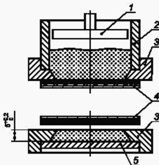
1 — плунжер (из неабразивного материала); 2 — цилиндр (из неабразивного материала); 3 — кольцо;
